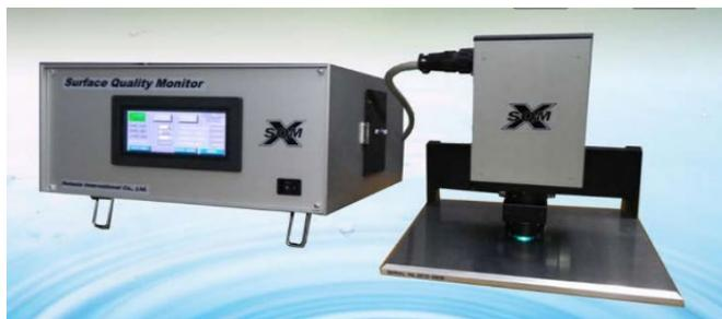
洗浄度検査装置
