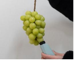
手のひらサイズでコンパクト 測定器単体で計測できます。 スマホにワイヤレスで接続しグラフ表示・データ保存等も可能です。 取得したデータを翌年以降の収穫にも活用できます。
