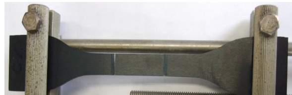
e-NBR: オゾン試験 1ppm 40°C 20%伸長 1000H: OK
