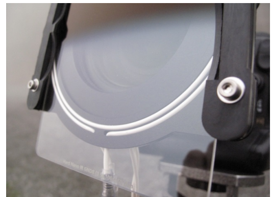
外気温 約8℃ 湿度100%(濃霧) ヒーター線通電有り くもり・結露無し
