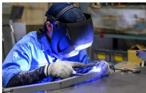
熟練工による溶接組立
