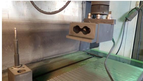
引抜の先端部は、XZ(YZ)軸放電加工で6面すべてを加工し、仕上げ、高精度・短納期・低コストを実現
