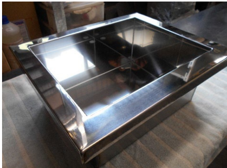
ロボットによる溶接・研磨仕上げ (酸洗い済み品)
