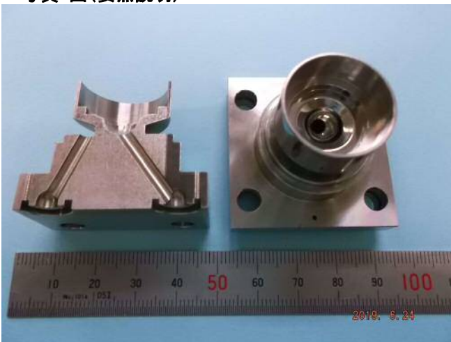
材質: SUS316L-P 球面斜め穴加工 公差0.02
