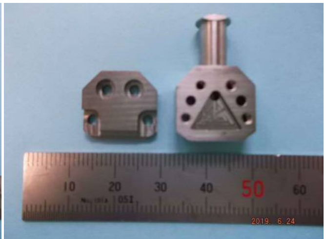
材質: SUS304 微細加工 M2タップ
