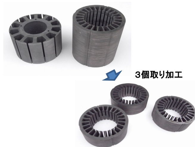
ケイ素鋼板を積層接着し加工
