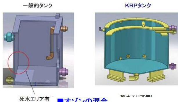
②タンク内での流体制御(攪拌・活性化・沈殿)
