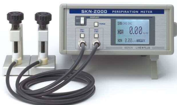
流量補償方式換気カプセル型デジタル発汗計
