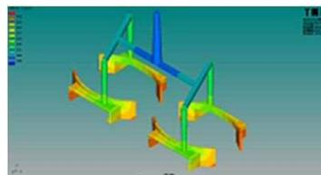
流動解析を行い、ゲート、ランナー、スプールの最適化及び、充填不良、ガスなどの不良予測を行い金型設計に反映します。
