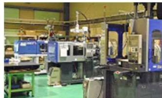
成形工場には、18~80トンの成形機5台を有し、これでトライすると共に、成形生産作業実績を金型設計に生かしています。
