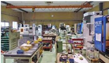
金型工場には、マシニングセンター、放電加工機、ワイヤーカット、NC旋盤、平面研削盤、汎用フライス盤を有し
