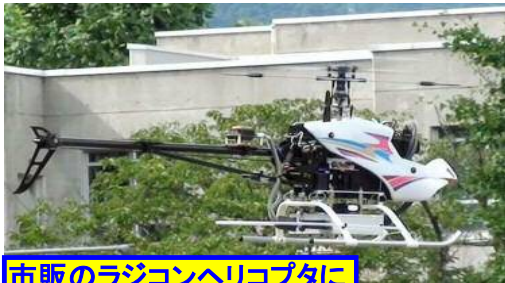
市販のラジコンヘリコプタに センサやコンピュータを搭載
