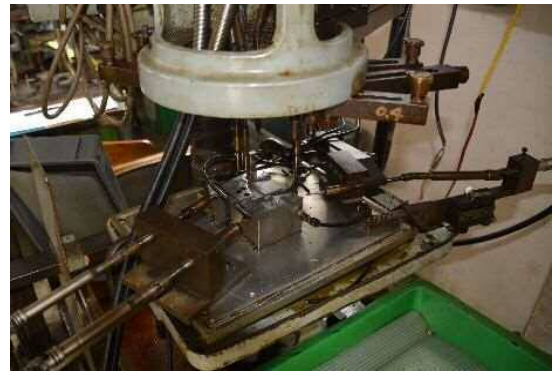
ワイヤーを利用した独自治具で 多方向からの同時タップを可能とし、 納期の短縮を図る
