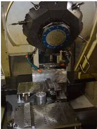
パレットチェンジャー搭載 マシニングセンターにて 作業の正確さと量産性を両立
