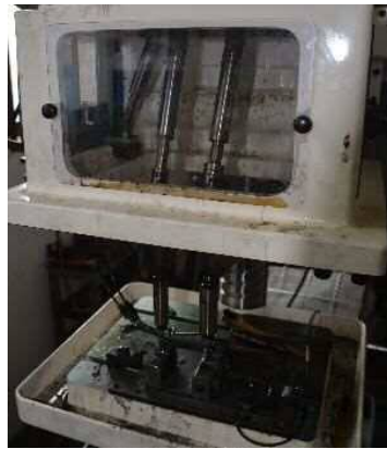
多軸タップ盤に センサー搭載治具を設置 工程漏れ・誤作動を防ぎ 正確な加工を行う
