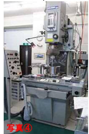
写真②: 内面研削盤 加工最小内径φ0.1~ 写真③: クリーンな恒温加工室 写真④: 治具グラインダー 加工最小内径φ0.1~
