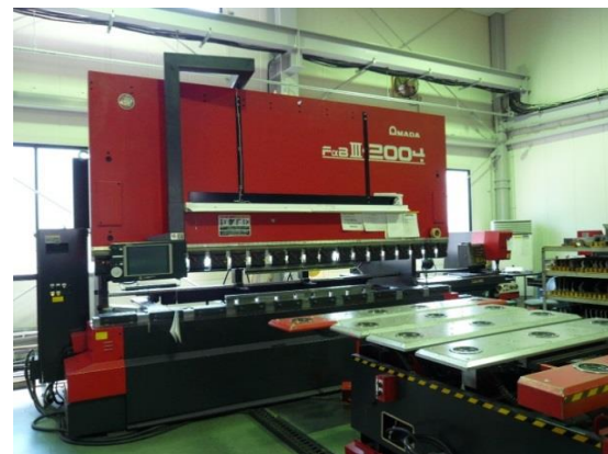
■ ベンディングマシン(FBDⅢ2004) 最大折り曲げ長さ 4000mm
