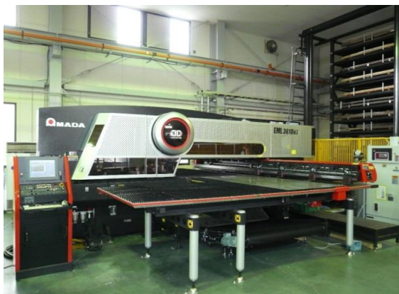
■ 複合加工機(EML3610NT) 最大加工サイズ 1524mm × 3048mm
