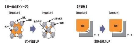
同一ボンド量でより強度のある砥石にできます。また同一結合度でボンド量を減らせ、気 孔率を高められる為、切粉の排出性、冷却性 を向上させ、研削性能がアップします。
