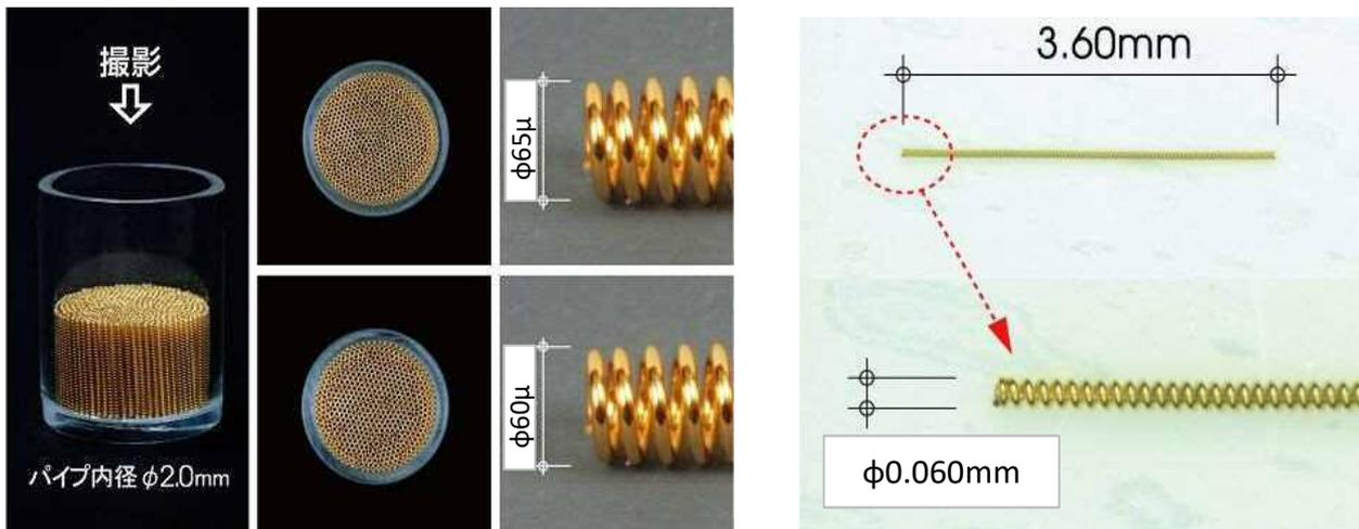
2018年 量産可能 線径φ15μm 外径φ65μm
